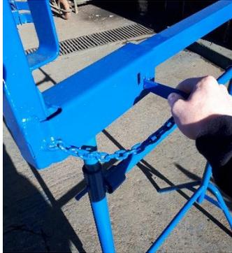
**FIG. 2** FITTING WEDGE
